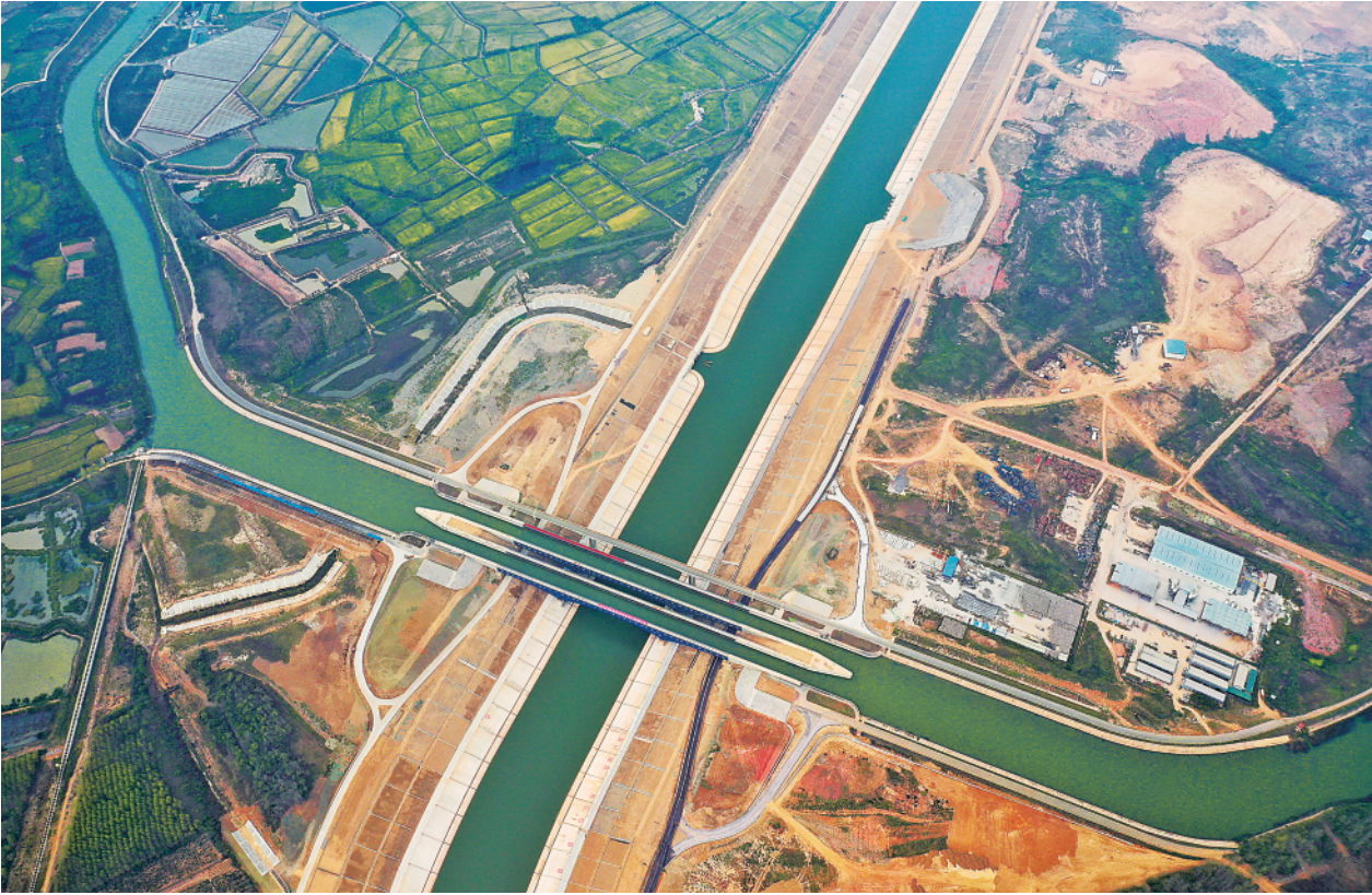
▲通航后的引江济淮 淮河总干渠 渡槽（二〇二二年九月二十三日摄）从空中俯瞰， 淮河总干渠从引江济淮运河上凌空而过，呈现出河上有河 的“水上立交”景象。
