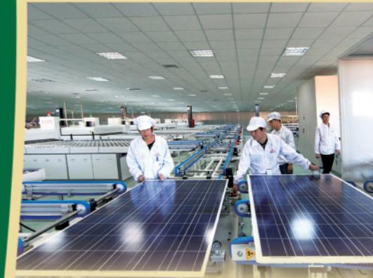
▲太阳能光伏电池板生产线。
