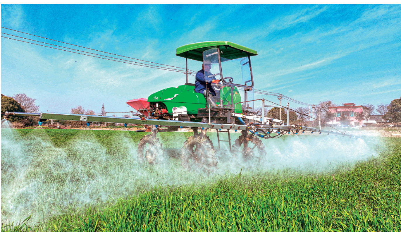
▲2月28日,在浙江省湖州市德清县禹越镇天皇殿村,农民驾驶自走式高杆喷雾机对小麦进行喷药作业。天气转暖,各地农民抢抓农时开展春耕备耕等农业生产,田间地头响起劳动的旋律,奏响春天的乐章。新华社(谢尚国摄)
