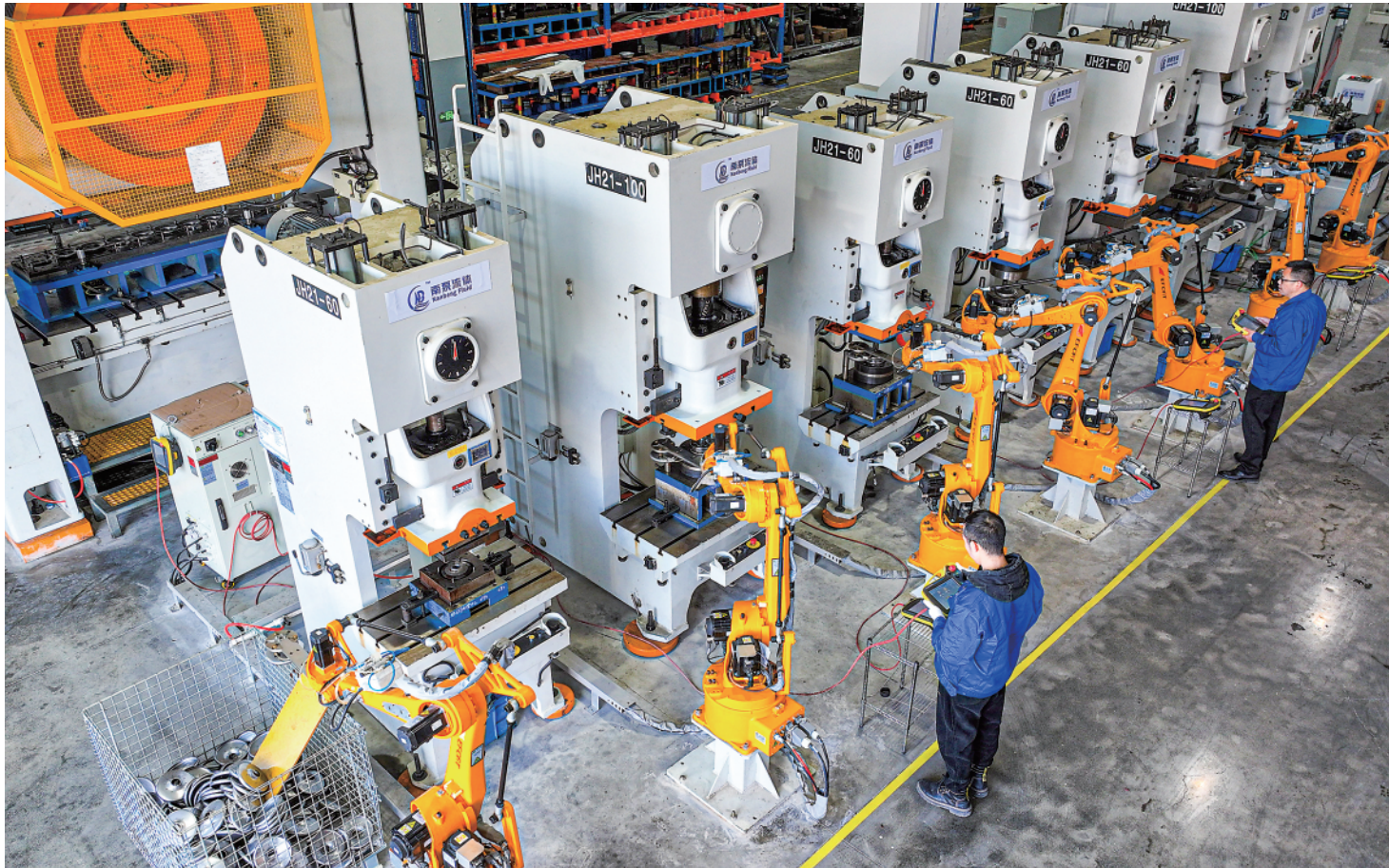
▲1月29日,在浙江省湖州市德清县钟管镇的浙江南泵流体机械有限公司生产车间内,工人在监测自动冲压线机械手工作情况,赶制水泵零配件(无人机照片)。 春节假期过后,各地企业开足马力加紧订单生产,生产车间一片忙碌。
