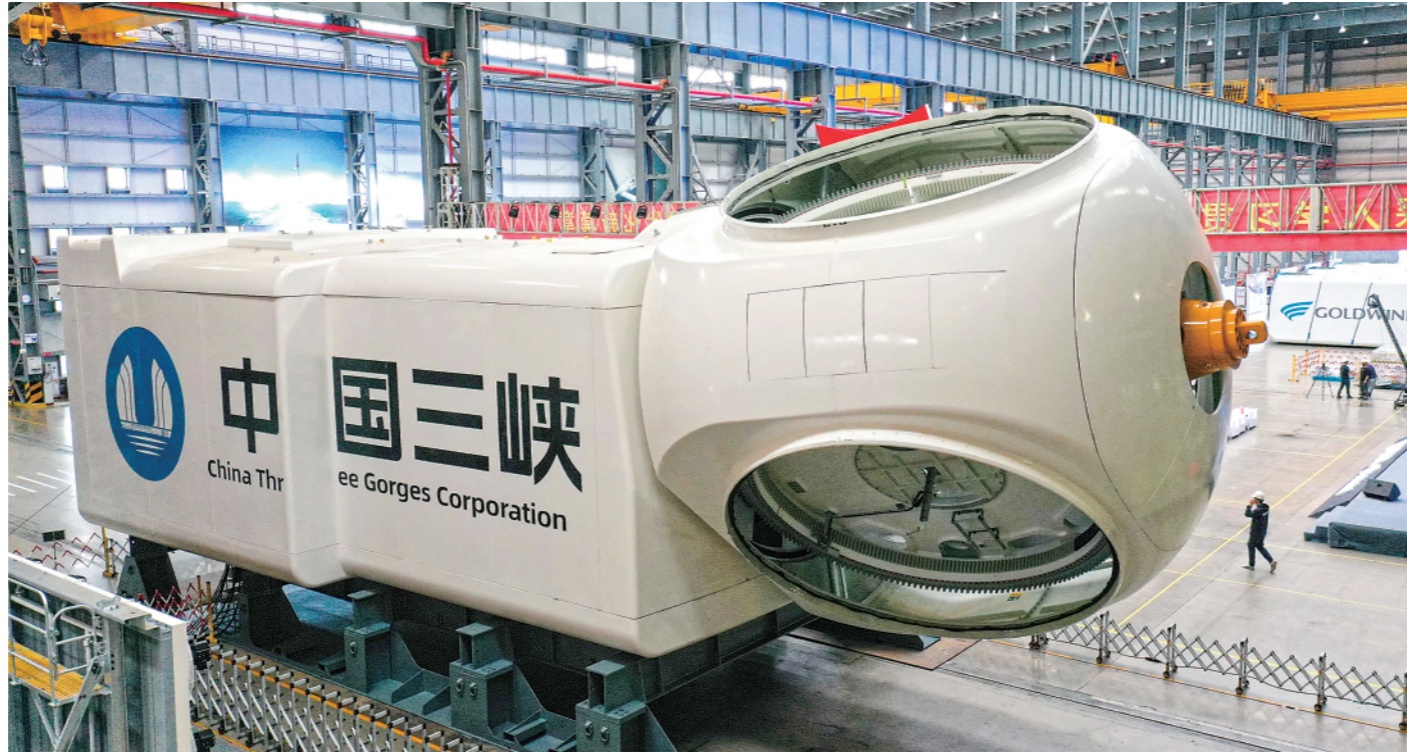
这是十一月二十三日在福建三峡海上风电国际产业园下线的十六兆瓦海上风电机组无人机组照片。新华社记者林善传摄
