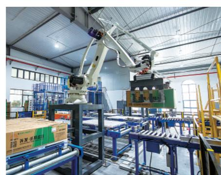
▲11月2日,在绍兴诚邦高新纤维科技有限公司自动化车间内,机械臂在运输装箱完毕的化纤材料。
