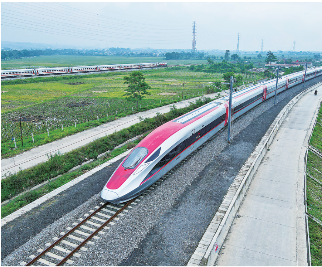
▲在印度尼西亚西爪哇省万隆市,一列高铁动车组正在雅万高铁试验段进行热滑试验(2022年11月9日摄,无人机照片)。
