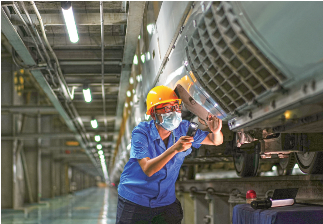
▲8月9日,在中国铁路上海局集团有限公司南京动车所内,南京电务段动车车载设备车间工作人员检修动车速度传感器。今年暑运以来,中国铁路上海局集团有限公司南京电务段动车车载设备车间工作人员针对高温天气等情况,加强列控车载设备检修工作,每日对动车进行“体检”,确保动车运行安全。
