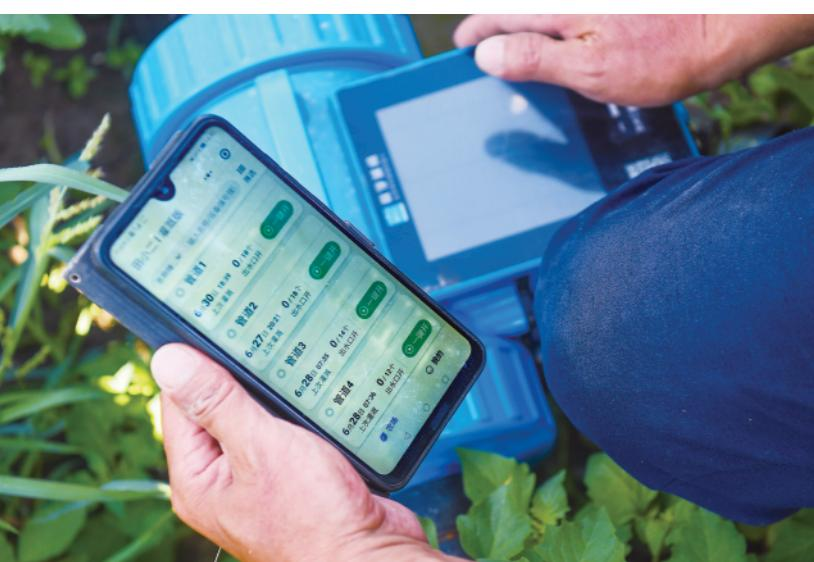
▲在位于新疆玛纳斯县境内的一处棉田里,种植户展示手机软件操控滴灌电磁阀开关,以控制棉田灌溉(6月30日摄)。新华社记者王菲摄
