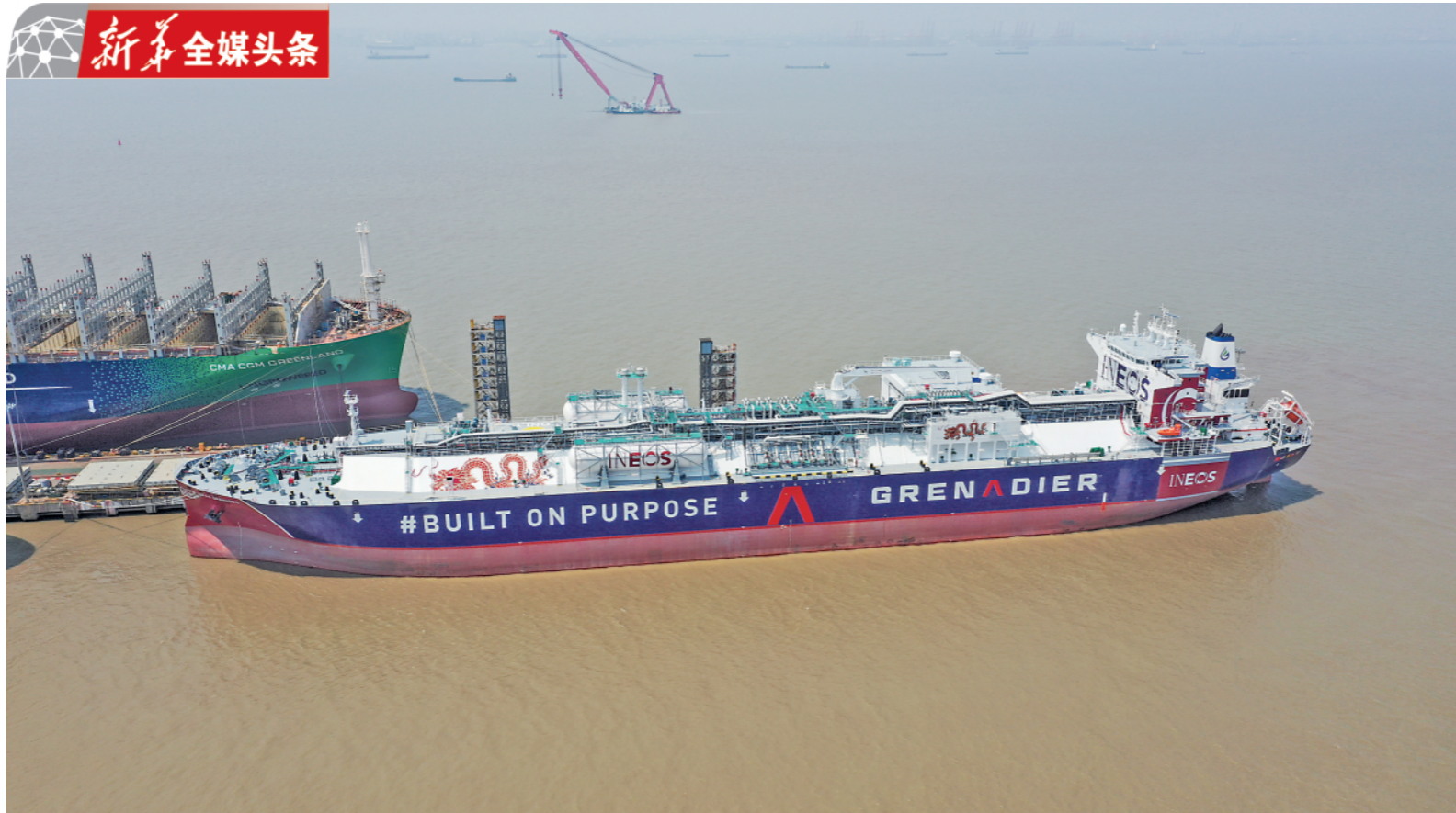
▲中国船舶集团旗下江南造船建造的99000立方米B型舱超大型乙烷运输船H2625船(5月16日摄)。
