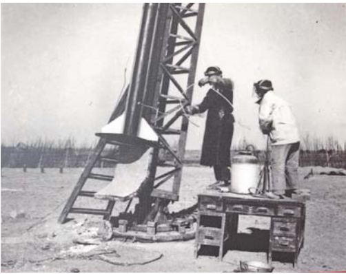
中国第一枚液体探空火箭T-7M001号火箭在发射前利用打气筒加注推进剂。（受访者供图）
