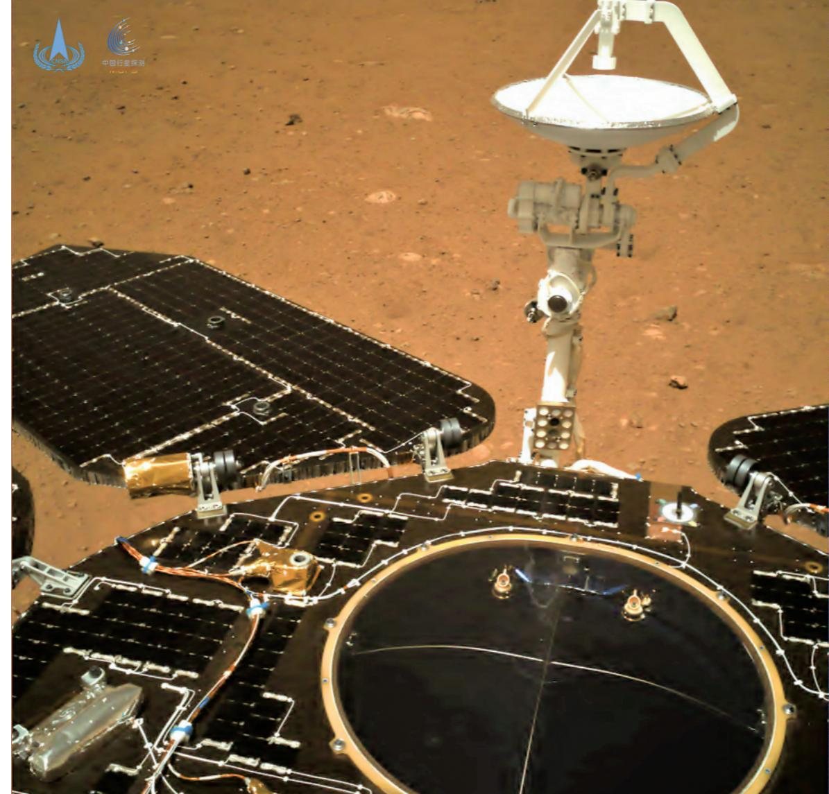
该图由火星车导航相机拍摄，镜头指向火星车尾部。图中可见火星车太阳翼、天线展开正常到位，火星表面纹理清晰，地貌信息丰富。
