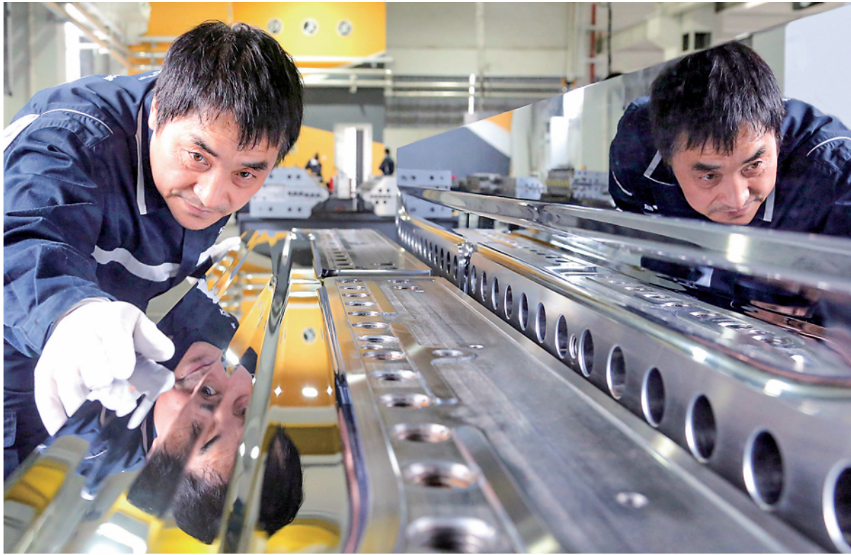
精诚员工正在检测挤出平模头核心流道。受访者供图
