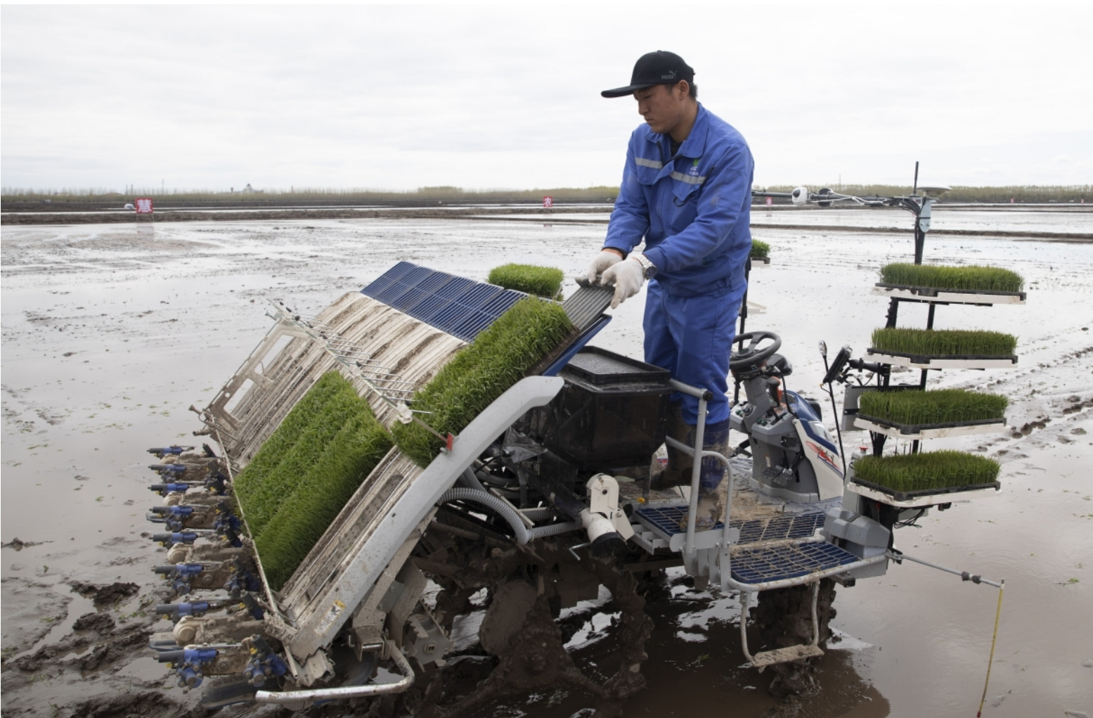
5月11日，在黑龙江北大荒集团红卫农场有限公司智慧农业先行示范区内，工作人员将水稻秧苗装进无人驾驶插秧机。据介绍，无人驾驶智能插秧机应用北斗卫星定位系统，可实现自动避障、掉头和转弯。同时，车体配备摄像头，将秧苗情况通过5G信号，实时传输到智慧农业中心，做到精准插秧，节省人力成本，提高作业效率和质量。新华社记者张涛摄
