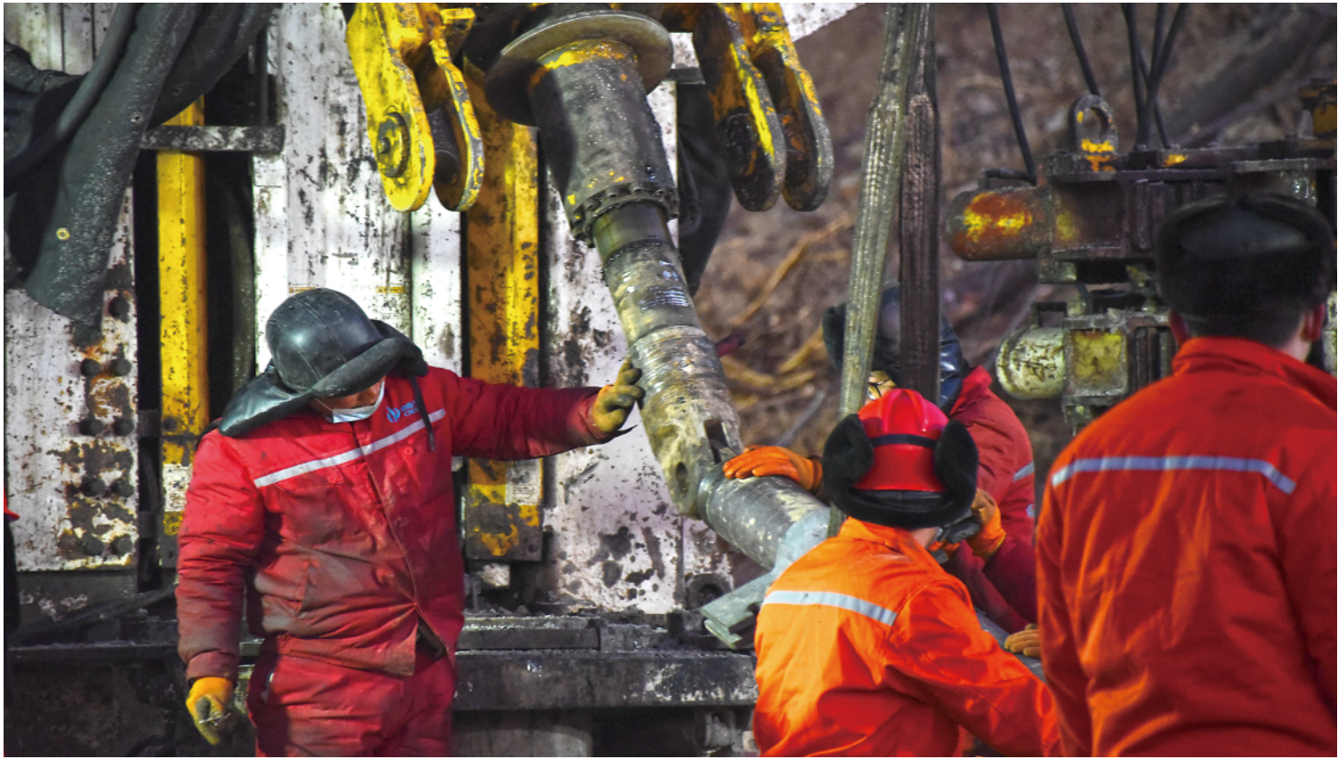
1月17日，救援人员在进行下套管作业，准备与被困人员取得联系。
