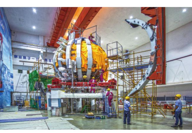
▲工作人员在安装调试中国环流器二号M装置时进行环线圈外弧段吊装工作(2020年7月19日摄)。新华社发
