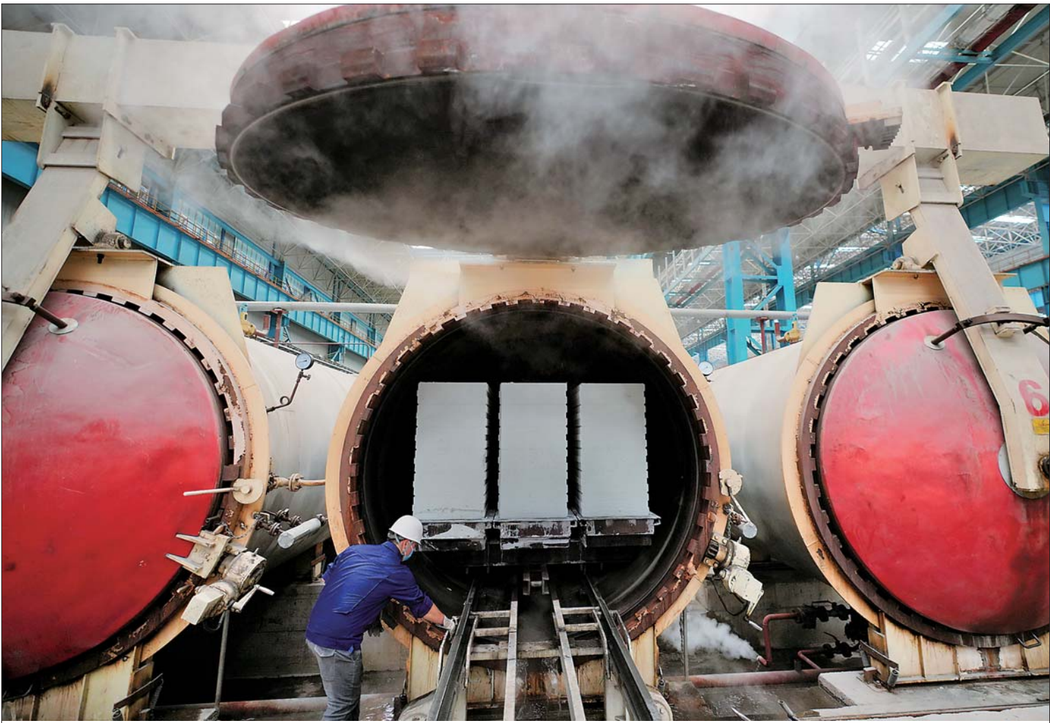
▲7月1日,工人在迁安市一家装配式建筑制品车间板材生产线上工作。近年来,河北省迁安市把矿山生态修复治理作为转型发展新的突破口,推进以尾矿砂为原料生产新型建材生产,使矿山废弃物“变废为宝”,促进生态修复与产业融合发展。目前年可消耗尾矿砂10万吨。 新华社记者杨世尧摄
