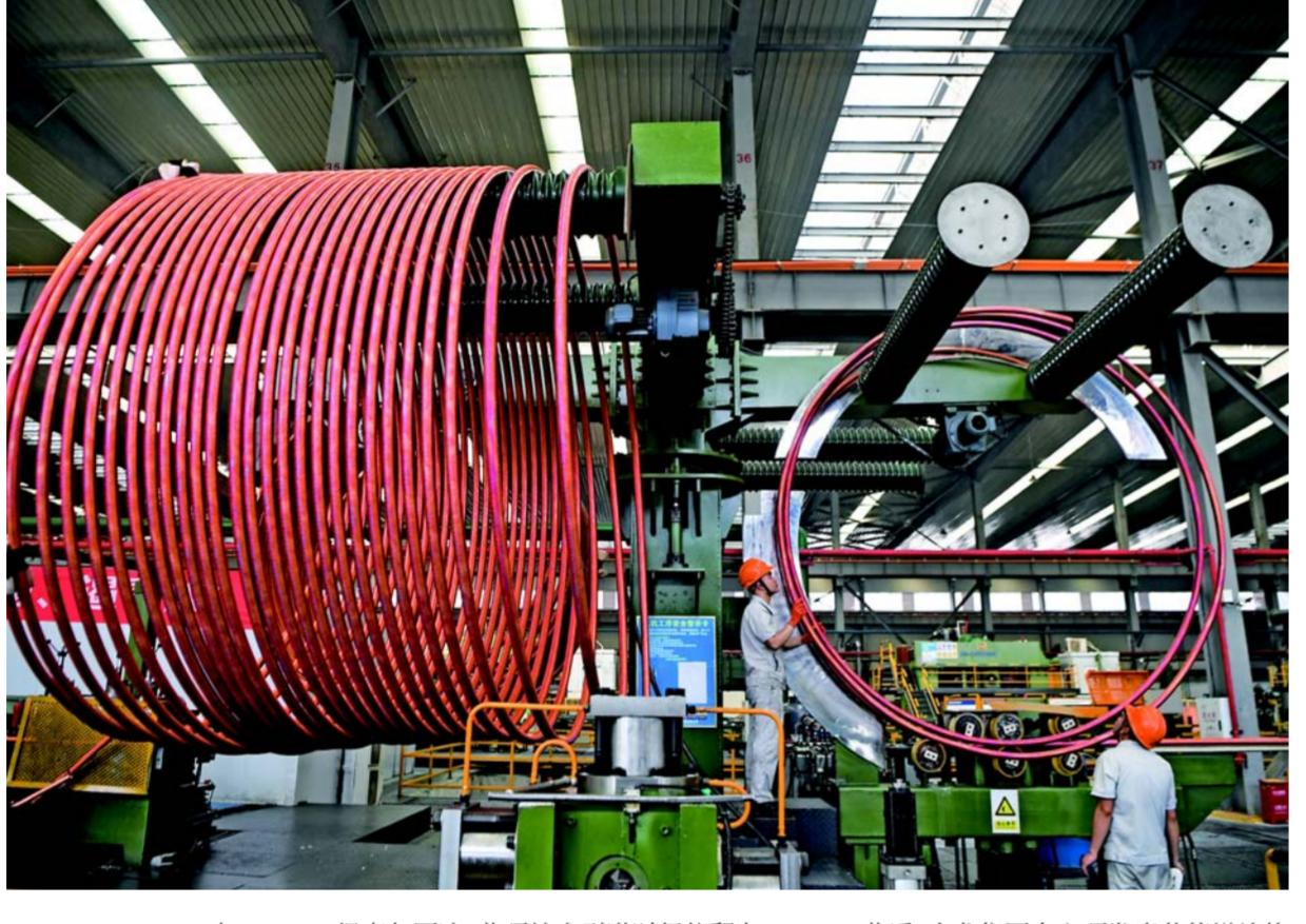
新华社重庆10月31日电(记者赵宇飞)走进金龙铜管集团的生产车间,机器轰鸣声中,一块块铜板仿佛被施了魔法,经过熔铸、轧制、联拉、退火等复杂工序,变成一根根不同规格的精密铜管。
