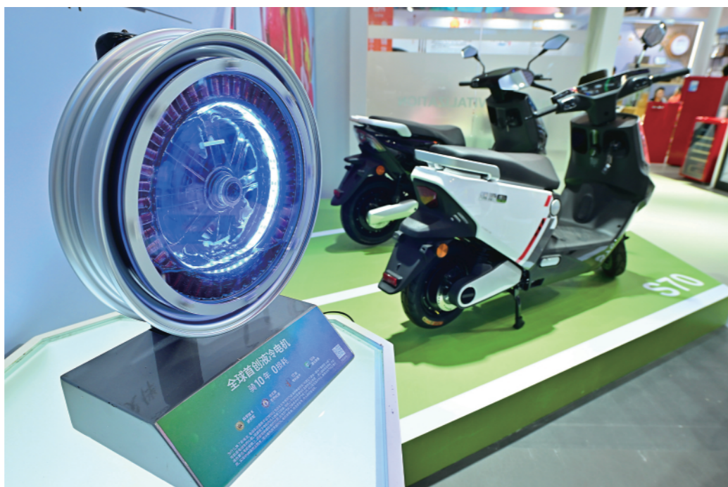
▲这是浙江展台展示的绿源电动车液冷机芯，它可以提高电机效率、增加电动车续航。第三届中国国际消费品博览会科技感十足，参展的各家中国企业将“科技感”满满的展品展示出来，让观众与前沿的国产科技亲密接触，体验国产“黑科技”。新华社记者李鑫摄
