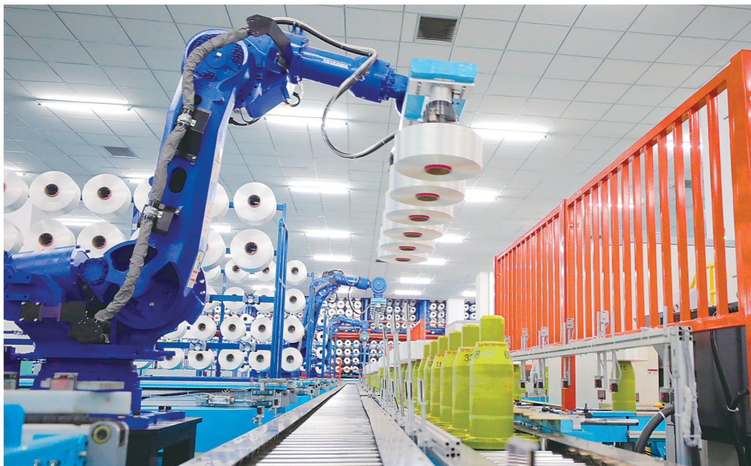
▲在恒力(苏州)产业园内的高性能涤纶工业丝智能车间内，机械手臂将检验合格的丝饼放上丝车，转运至智能立体仓库(3月15日摄)。江苏省苏州市吴江区是我国重要的制造业基地，聚集了一批民营高新技术企业、创新型中小企业等。近年来，当地推出促进科技创新、强化金融支撑、助力降本减负等多方面政策措施，促进民营企业健康发展。 新华社记者毛俊摄
