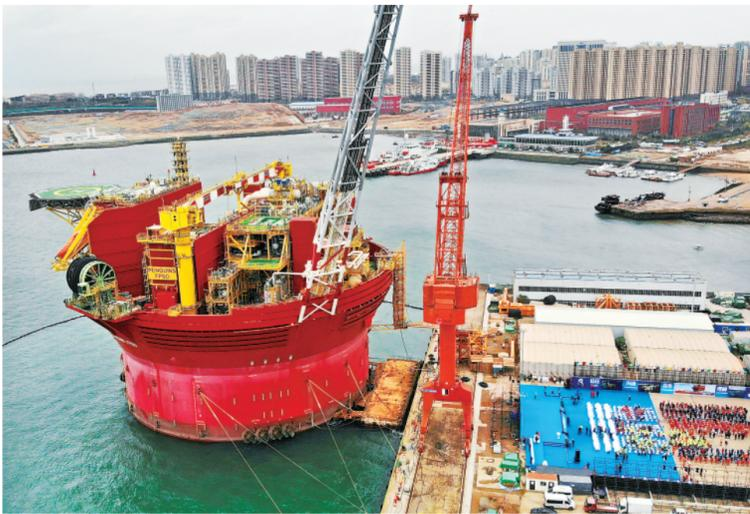
▲这是11月29日在山东青岛拍摄的企鹅圆筒型浮式生产储卸油装置(FPSO)交付现场(无人照照片)。当日，由海洋石油工程股份有限公司为英国业主量身定制的“海上油气巨无霸”——巨型智能集成化圆筒型浮式生产储卸油装置(FPSO)在山东青岛顺利交付。该装置整体高度118米，总重约3.2万吨。
