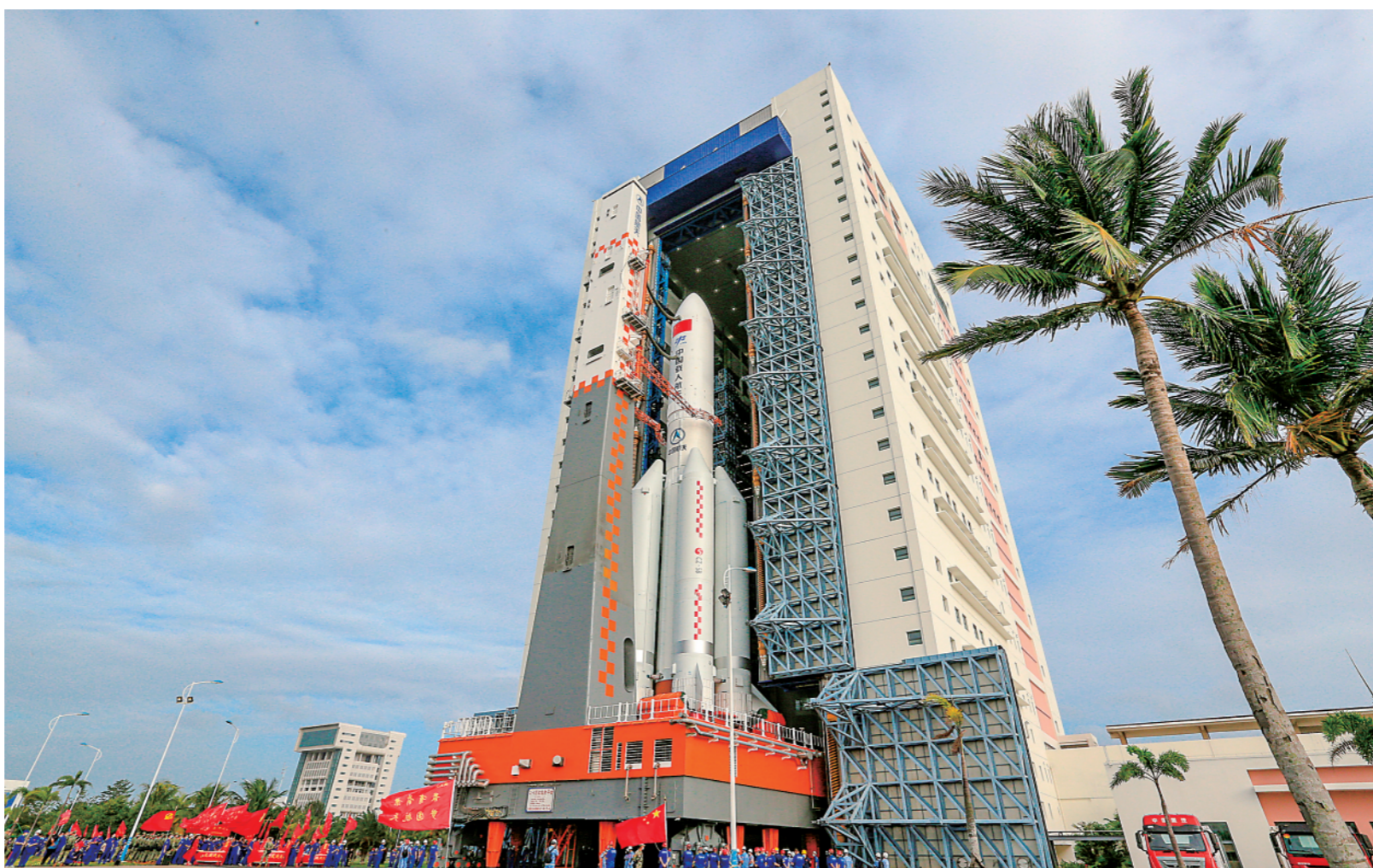
▲10月25日,梦天实验舱与长征五号B遥四运载火箭组合体在活动发射台牵引下缓缓驶出垂直总装测试厂房。新华社发(屠海超摄)
