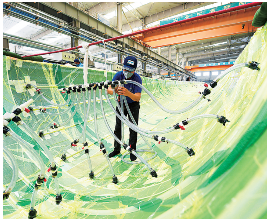
▲9月28日，在位于信阳高新区的一家智慧能源有限公司，工作人员为风电设备安装灌注树脂用的钢丝水管。 新华社记者张浩然摄
