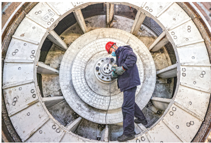
▲北方重工员工正在组装出口印度尼西亚的风扇磨煤机。(受访者供图)
