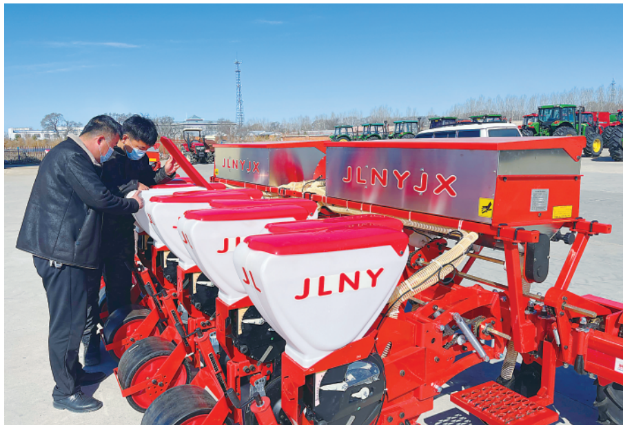
▲北大荒集团军川农场有限公司新购进的气吸式精量播种机(4月12日摄)。
