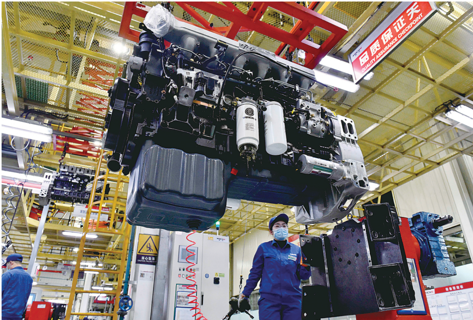
▲在位于山东潍坊的潍柴集团总装车间,工人在流水线上装配发动机(2021年4月22日摄)。新华社记者郭绪雷摄
