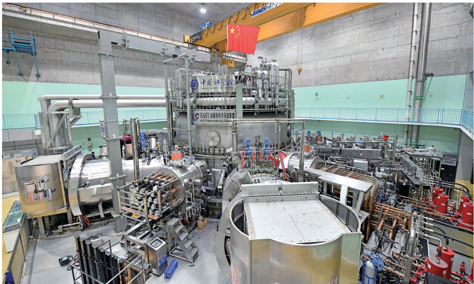
这是中科院合肥物质科学研究院有“人造太阳”之称的全超导托卡马克核聚变实验装置(EAST)。
