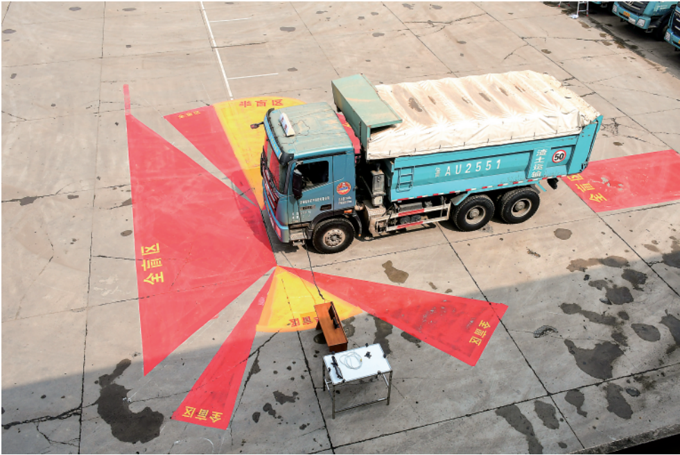
大货车右转盲区示意图(济南交警提供)。新华社发
