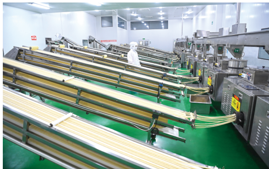
▲在制药级洁净车间内,面粉经过挤压熟化,类似于高压锅蒸馒头。图片由受访者提供
