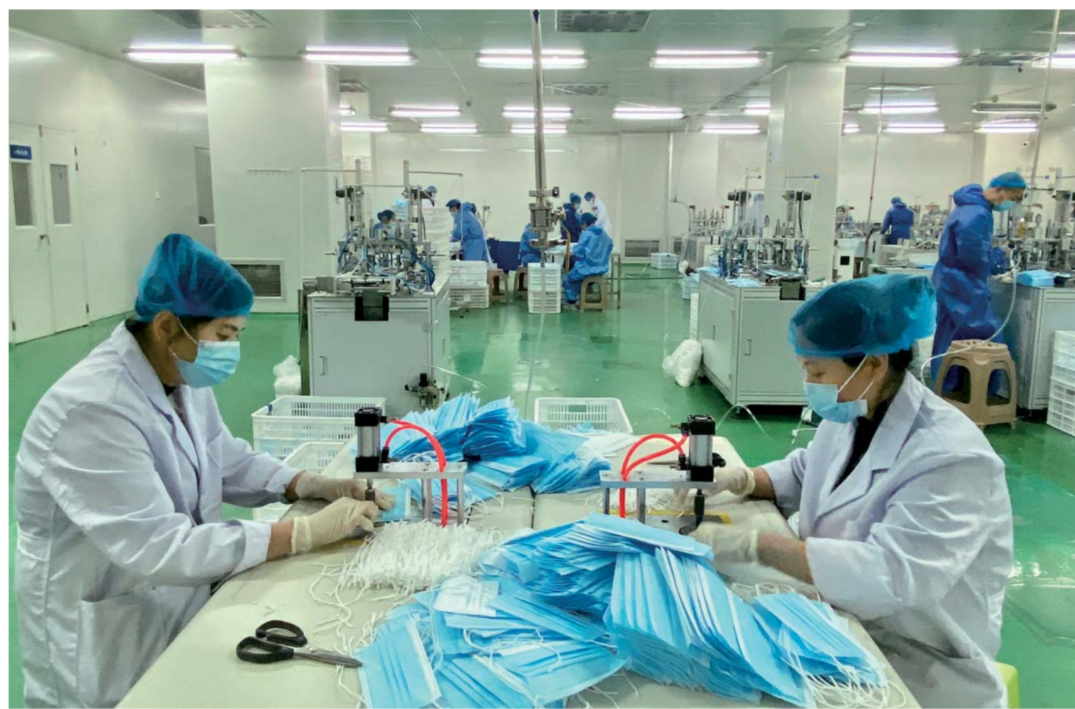
小图：在哈尔滨一家口罩生产企业，由于新购置的全自动口罩生产线故障频发，多名技术人员在对设备进行检修(3月24日摄)。 大图：在哈尔滨一家口罩生产企业，由于新购置的口罩生产线难以实现全自动操作，工人们手动焊接口罩耳带(3月24日摄)。
