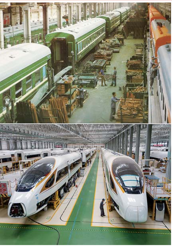
▲上图为上世纪90年代的长春客车厂载客车列车装配生产线(资料照片);下图为2019年6月20日,中车长春轨道客车股份有限公司(中车长客)工人唐建坤(前)在中车长客高速动车组制造中心检查“复兴号”动车组列车底部电气系统(新华社记者张楠摄)。
