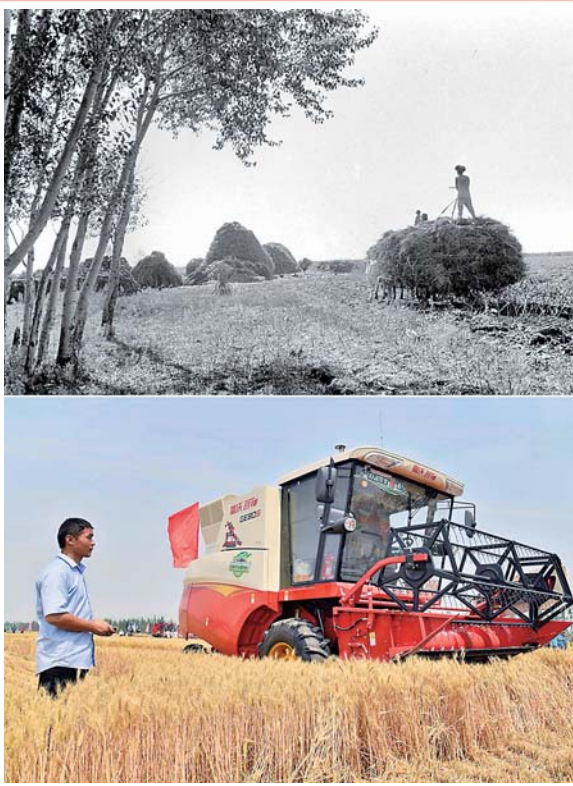
▲上图为1949年10月8日,黑龙江讷河农民在秋收(新华社记者王纯德摄);下图为2019年5月31日,在山东省济宁市嘉祥县仲山镇,雷次重工股份有限公司工作人员在遥控指挥自动驾驶收割机作业(新华社记者郭继雷摄)。如今,无人驾驶收割机安装了自动驾驶系统,可以实现高精度定位,自动路径规划和无人驾驶行驶。
