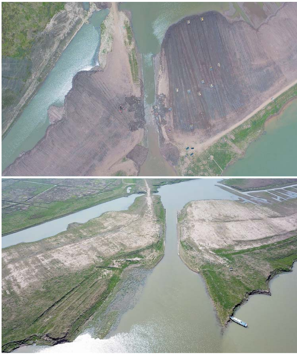
▲这是一张拼版照片。上图：2018年6月15日无人机拍摄的数台大型机械在下塞湖矮围节制闸口作业(丁春雨无人机摄)；下图：下塞湖矮围节制闸口经过爆破和清淤疏浚，堤坝已被铲平，堤外湖与堤内水连通(2019年3月12日陈泽国无人机摄)。 新华社发
