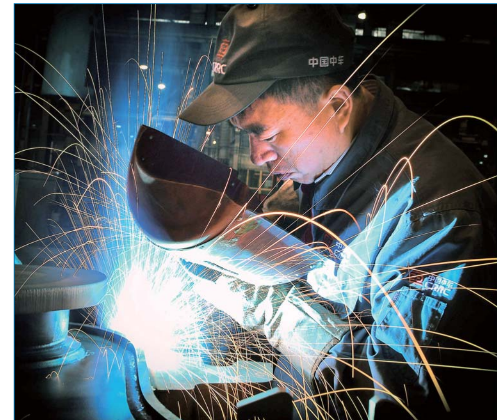
右图:全国人大代表张敬华呼吁,加大力度培养高级技术人员,弘扬工匠精神,打造“大国工匠”。 左图:中车长客股份有限公司转向架制造中心焊接工人李万君在焊接动车组转向架侧梁(2017年4月23日摄)。李万君坚守焊接岗位30年,奋力攻克高铁领域的技术难关150多项,获得国家专利20多项,被尊称为“工人院士”。 新华社记者杨宗友摄 新华社记者许畅摄
