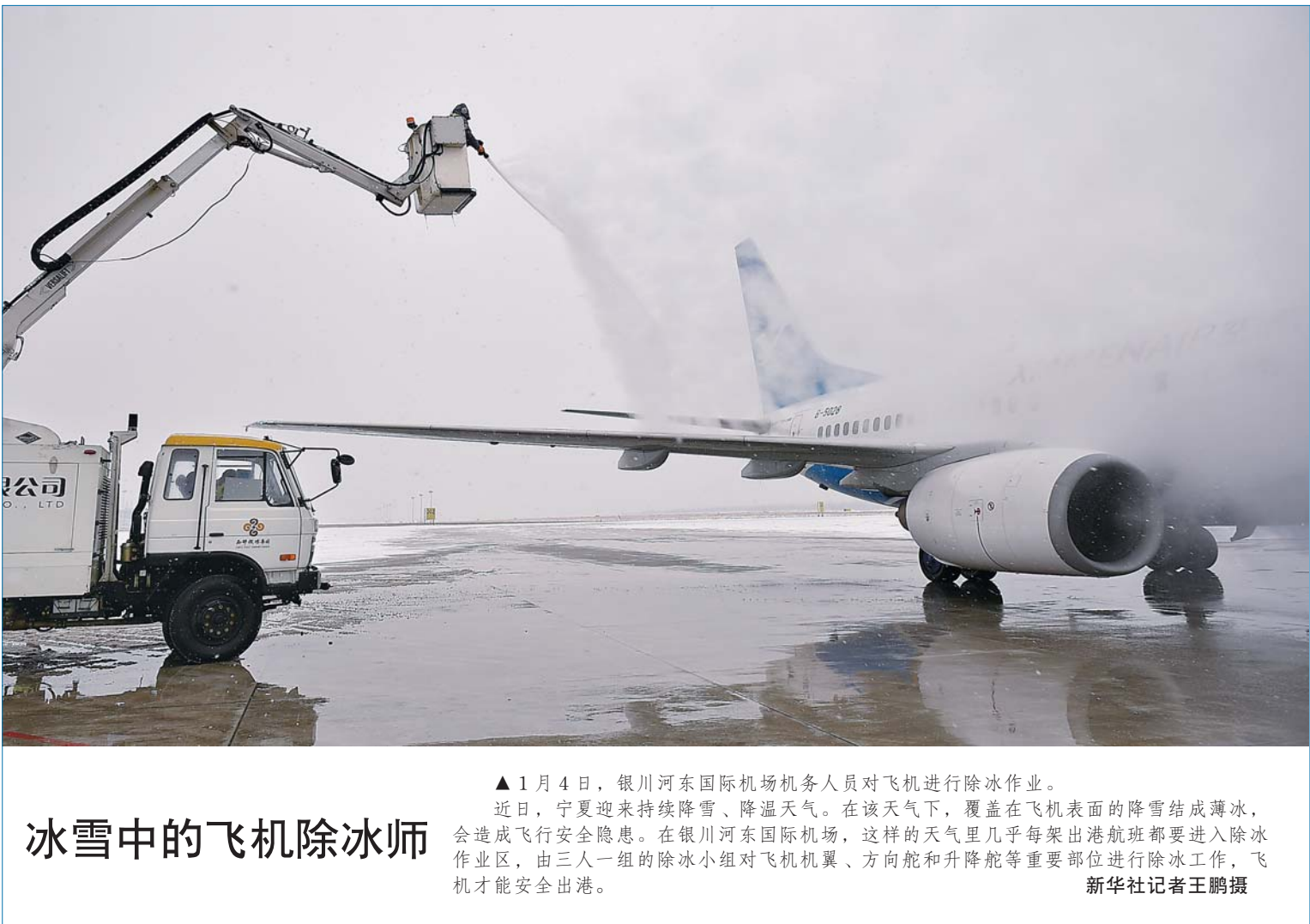
▲ 1 月 4 日，银川河东国际机场机务人员对飞机进行除冰作业。近日，宁夏迎来持续降雪、降温天气。在该天气下，覆盖在飞机表面的降雪结成薄冰，会造成飞行安全隐患。在银川河东国际机场，这样的天气里几乎每架出港航班都要进入除冰作业区，由三人一组的除冰小组对飞机机翼、方向舵和升降舵等重要部位进行除冰工作，飞机才能安全出港。
